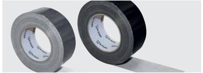
Nastro PE Duct, composto da un tessuto di alta qualità e polietilene colorato, con adesivo a base gomma sintetica. Buona resistenza alla trazione e eccellente resistenza all'umidità. Si adatta perfettamente alla superficie irregolari. È una buona scelta per manutenzioni, isolamento di tubi, fissaggi vari, sigillatura di canali e condotte HVAC.
