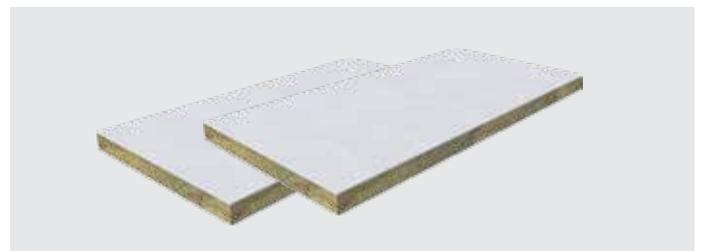
Il pannello K-FLEX® K-FIRE BOARD è realizzato in lana minerale con una densità di 160 kg/m<sup>3</sup>, rivestito su uno o entrambi i lati con vernice acrilica K-FLEX® K-FIRE COATING. Viene utilizzato per sigillare pareti e soffitti, passaggi di tubi in acciaio e rame e passaggi combinati con tubi di plastica, cavi e condotti di ventilazione.
