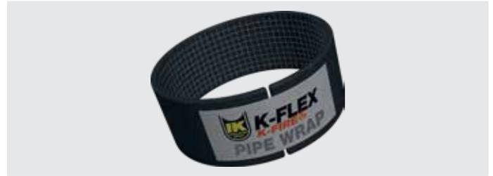
Il K-FLEX® K-FIRE WRAP è un dispositivo di chiusura per tubazioni ideato per sigillare attraversamenti di tubazioni combustibili, tubazioni combustibili coibentate in pareti e solette. Il K-FLEX® K-FIRE WRAP è fornito in sacchetti di polietilene pre-dimensionato a seconda del diametro del tubazione. La striscia è avvolta attorno alla tubazione e spinta nell'apertura dell'elemento di separazione o inglobato nel getto con K-FLEX® K-FIRE EX MORTAR.
