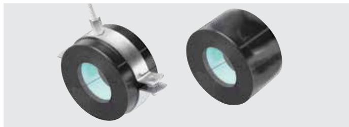
Realizzato per garantire il corretto spessore dell'isolante nei punti in cui sono previsti i fissaggi. La parte centrale in PIR, su tutta la circonferenza, unita a due corone laterali di isolante di K-FLEX®, garantisce la continuità della barriera al vapore.
